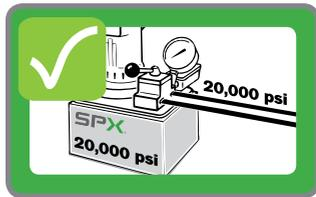
Rester vigilant aux pressions du système. Ne pas utiliser de pompe 20 000 psi sur un système avec des composants 10 000 psi (flexibles, raccords, valves, outils, etc.).
