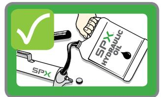
Utiliser uniquement de l'huile de très bonne qualité, comme l'huile hydraulique SPX Power Team. L'utilisation de fluides inappropriés peut endommager l'équipement et provoquer des pannes prématurées.
