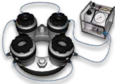
Monter les tendeurs sur 50% des boulons.
