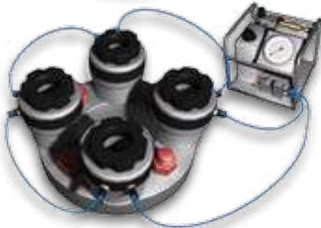
Déplacer les tendeurs sur les 50% de boulons restants et appliquer la « pression 2 » comme indiqué sur la fiche de données de tension de boulon.
