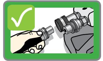
Nettoyer les deux extrémités des coupleurs avant l'assemblage.
