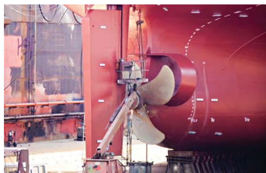
Photo ci-dessus : Installation d'un gouvernail pour l'entretien de routine dans une application de cale sèche.
