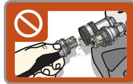
Nettoyer les deux extrémités des coupleurs avant l'assemblage.
