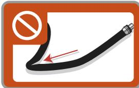
Ne pas plier les flexibles hydrauliques.
