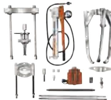
Cet ensemble comprend un extracteur 3 griffes et un extracteur Bi-Directional™. Idéal pour les travaux lourds. Cet ensemble convient aux travaux sur des engrenages, roulements, roues, poulies, etc., de grandes dimensions.
