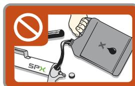
Utiliser uniquement de l'huile de haute qualité, comme l'huile hydraulique SPX Power Team. L'utilisation de fluides inappropriés peut endommager l'équipement et provoquer des pannes prématurées.
