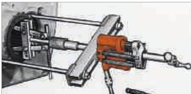
La combinaison d'un extracteur Bi-Directional™ de 50 tonnes et d'un accessoire d'extraction de cuvettes simplifie la dépose d'un joint pour l'essieu moteur final.
