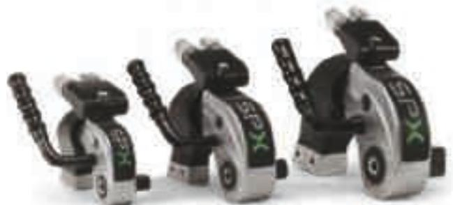
Le mécanisme à longue course de l'outil transmet une rotation d'écrou de 30 degrés minimum par course, tout en maintenant un rayon de tête étroit et compact : d'où un net avantage comparé aux mécanismes à course courte et à cliquet de retour des modèles en alliage léger de la concurrence. Moins de pièces et une torsion réduite pendant le fonctionnement d'où une diminution de l'usure et des coûts de maintenance et annexes.
