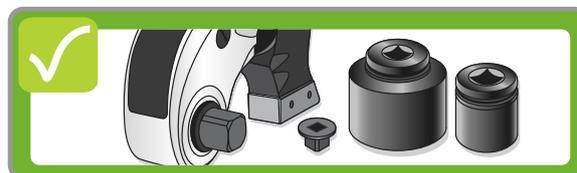
Utiliser uniquement des douilles à impact et des réducteurs de haute qualité, à la charge nominale et au facteur de sécurité appropriés.
