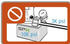
Rester vigilant aux pressions du système. Ne pas utiliser de pompe 700 bar sur un système avec des composants 207 bar (flexibles, raccords, valves, outils, etc.).
