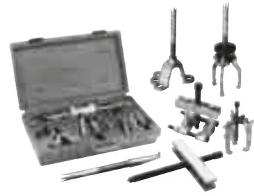
Les éléments peuvent être assemblés pour créer différentes versions polyvalentes d'extracteur. La tête de l'extracteur se tourne pour verrouiller les griffes sur la pièce à déposer. Comprend une tête d'extracteur à 2 et 3 positions, plus trois griffes à portée longue et trois à portée courte dans un coffret de rangement en plastique. Pour la dépose aisée d'engrenages, de roulements et autres pièces montées en force.
