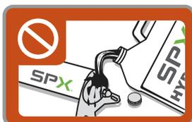
Ne pas trop remplir les réservoirs des pompes.
