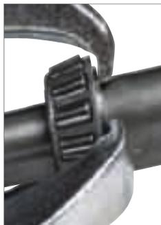
La griffe conçue en forme de cône permet un serrage sur le roulement pour une extraction parfaite.
