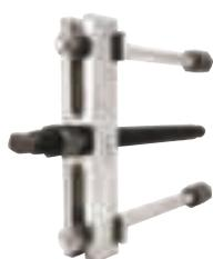
**Extracteur Bi-Directional™ :** Peut se visser directement dans une pièce fileté pour une dépose facile et sûre. Les extracteurs Bi-Directional™ peuvent être utilisés en association avec des accessoires d'extraction de roulements et de poulies qui saisissent la pièce par derrière. Un large assortiment d'adaptateurs filetés mâles et femelles est disponible ainsi que des adaptateurs métriques.
