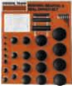
Ces jeux comprennent des disques et des poignées permettant de composer un outil « sur mesure » composé d'un « pilote » (pour éviter une bascule), d'une entretoise (pour une application de la force sur la zone adéquate) et d'une entretoise manchon (pour une répartition homogène de la force). Les disques ont un diamètre allant de 12,7 à 114,3 mm par incréments de 1,6 mm. Chaque jeu est fourni avec un coffret pratique en plastique comportant un plateau prédecoupé à la forme des outils.
