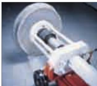
La photo ci-dessus montre l'extracteur universel en position sur le roulement à rouleaux, qui est prêt pour la dépose.
