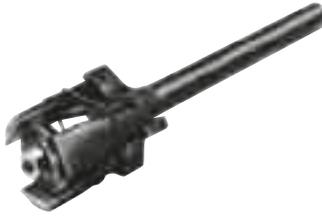
Cet outil permet la pose de cuvettes de roulement présentant un diamètre extérieur de 92 à 165 mm. Il remplace plus de deux douzaines de plaques et d'entraînements. Ajuster simplement les griffes au diamètre intérieur de la cuvette, verrouiller les griffes, emmancher la nouvelle cuvette et la mettre en place avec un marteau.
